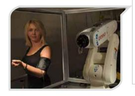
可检测肌肉收缩的可穿戴传感器,可以帮助截肢患者更好地控制假肢。它由光源和四个光电探测器组成,可以测量放松肌肉和收缩纤维肌肉上光线散射之间的差异。如果肌肉收缩,光线散射就会随着肌肉纤维的拉开移动而掉落。然后信息就会以光电流的形式传到机械手臂上,根据肌肉的状态执行动作。
